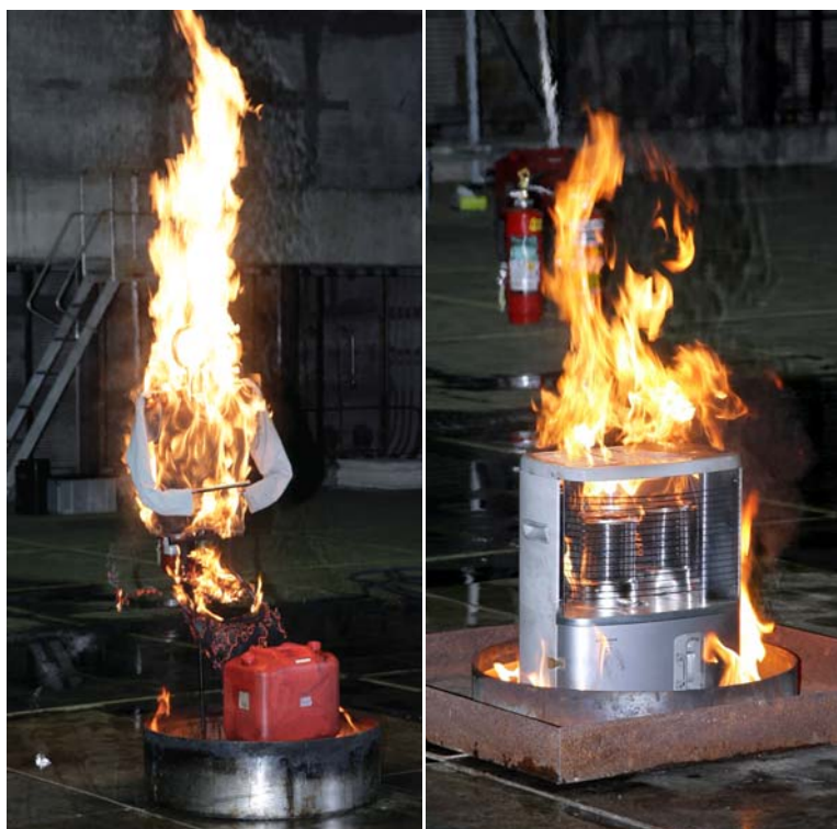
写真1 ポリタンク容器から漏えいしたガソリン可燃性蒸気に引火した場合の実験
